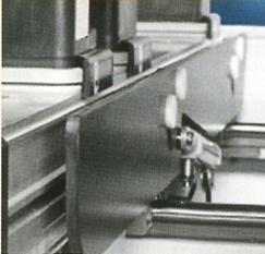
4 robuste Einlegehilfen zum Belegen schwerer Werkstücke
