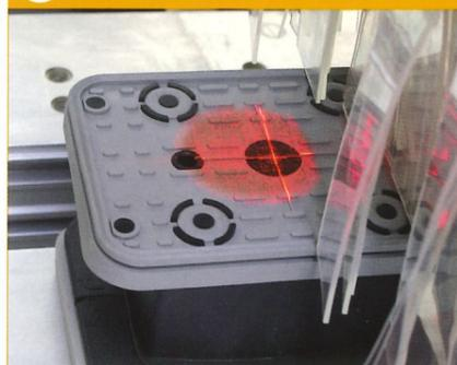
Einfaches Positionieren der Sauger durch den Fadenkreuzlaser
