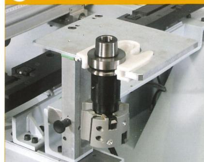
Sicheres und schnelles Beschicken des Werkzeugwechsellmagazines
