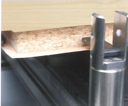
Gewährleistet einfaches Positionieren bei Material mit Furnierüberstand
