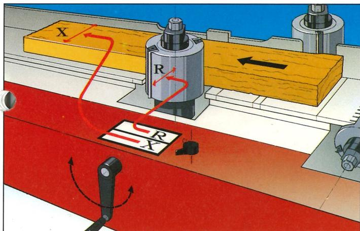
Weinig DigiSet für linke und obere Spindel. Werkzeug über digitale Doppelanzeigen direkt einstellbar. Fertigmaß in Breite und Dicke stets ablesbar.
