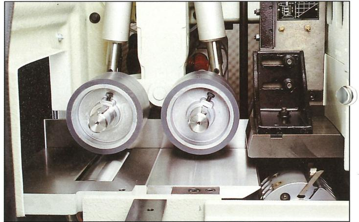
Präzise Holzführung nach oberer und über unterer Spindel: Optimal-Oberfläche und Parallelität. Angetriebene Auszugswalzen über und im Tisch: sicherer Werkstückauszug, auch bei Dünnpapier. Die Tischwalze ist in der Höhe verstellbar.
