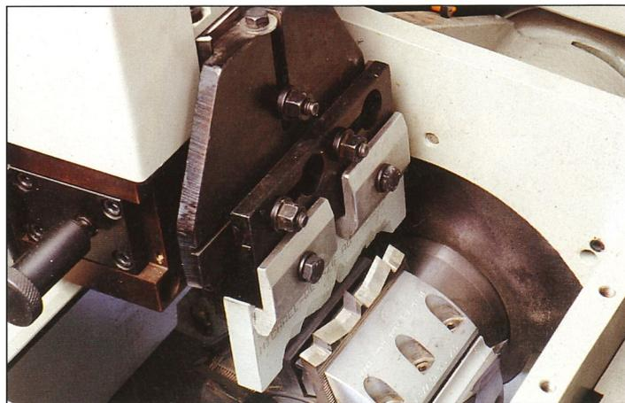
Ferngesteuerte, vollautomatische Profiljointer! Alle Schneiden im Messerkopf haben so immer den gleichen Flugkreis-Durchmesser. Das garantiert wiederholbare Profilgenauigkeit, lange Standzeiten und Super-Oberflächen.
