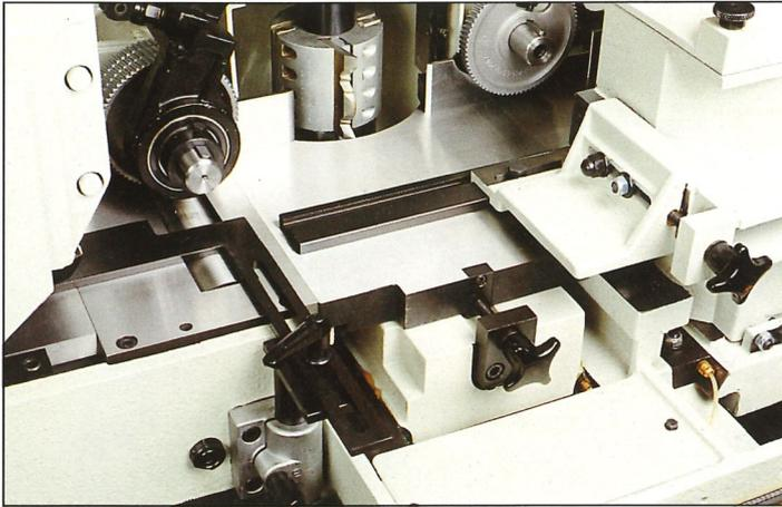
Rapidverstellung der Tischeinlage. Kein Verschleiß der Spindelschieber durch aufgedoppelte Tischplatten-Elemente.
