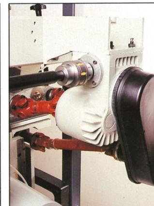
Antrieb durch Kardan-gelenke: robuster, wartungsfrei, langlebiger, präziser.
