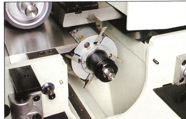
Große Flugkreise an allen Spindeln! Dadurch große Werkzeuge einsetzbar. Dadurch große Profil- und Schnittiefen.
