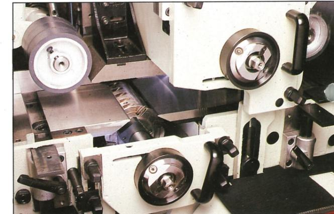
Neue Gegenlager! Das bewährten Hydro-Spann-System gewährleistet höchste Oberflächenqualität über die gesamte Arbeitsbreite. Auch bei hohen Vorschubgeschwindigkeiten mit gejointeten Werkzeugen. Auch bei hohen Belastungen. Durch verschiebbare Gegenlagernabe ist bei geschlossenem Gegenlager die volle Axialverstellung möglich.
