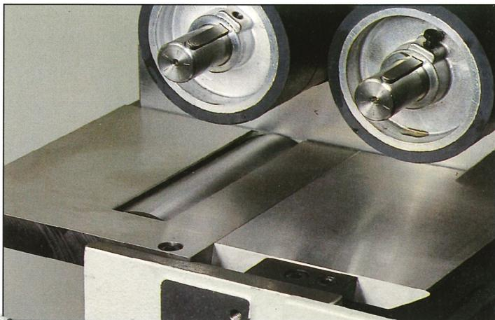
Verstellbarer Auslauftisch nach der unteren Profilierspindel. Schnell Rüsten. Keine Einschläge.
