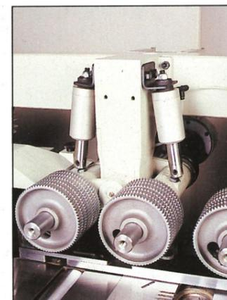
Pneumatischer Walzenandruck auch für verschieden dicke Werkstücke.
