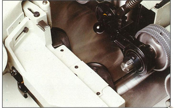
Seitliche Druckrollen führen auch kurze und schmale Werkstücke.
