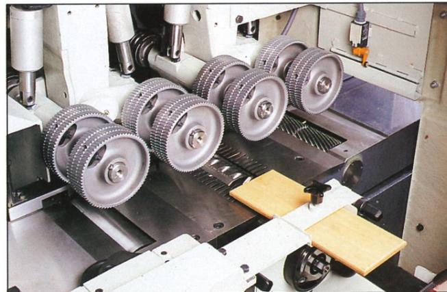
Massives Vorschubsystem mit Hydraulik-Antrieb gewährleistet auch bei Vorschubgeschwindigkeiten bis 80 m/min. die Hydroqualität der Werkstücke.
