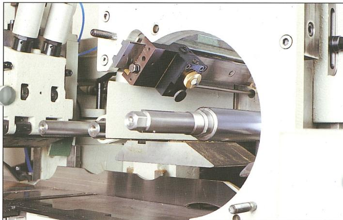
Fernbedienbarer Geradjointer! Die automatische Jointsteinzustellung garantiert eine schnelle, fehlerfreie Bedienung. Optimale Ergebnisse bei der Hobelqualität. Bedienung bei geschlossener Haube.
