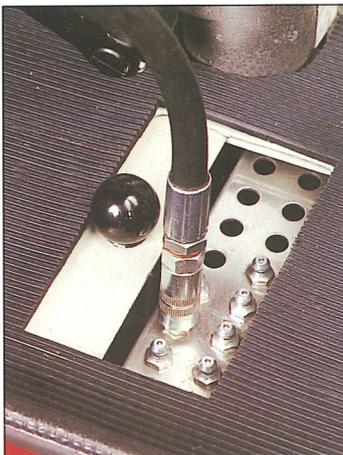
Zentrale Position der Schmierstellen, dadurch geringer Wartungsaufwand. Sie vergessen keine Schmierstellen, auch die der axialen Spindelverstellungen nicht.
