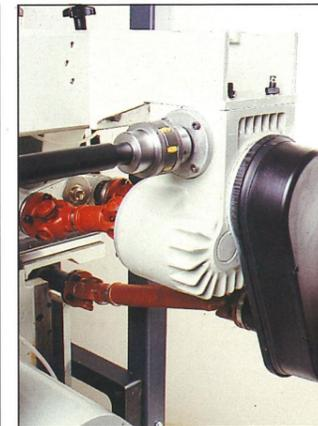
Antrieb durch Kardan-gelenke: robuster, wartungsfrei, langlebiger, präziser.
