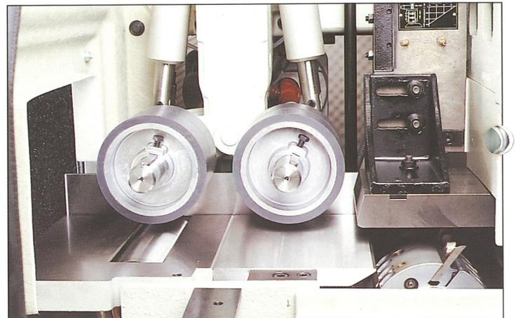
Präzise Holzführung nach oberer und über unterer Spindel: Optimal-Oberfläche und Parallelität. Angetriebene Auszugswalzen über und im Tisch: sicherer Werkstückauszug, auch bei Dünnware. Die Tischwalze ist in der Höhe verstellbar.
