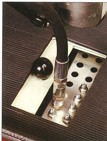
Zentrale Position der Schmierstellen für alle Tische und Spindelschieber, wie auch der Schieber für das Vorschubsystem. • Einfache Wartung • Stellt sicher, daß alle Punkte, die geschmiert werden, auch erreicht werden
