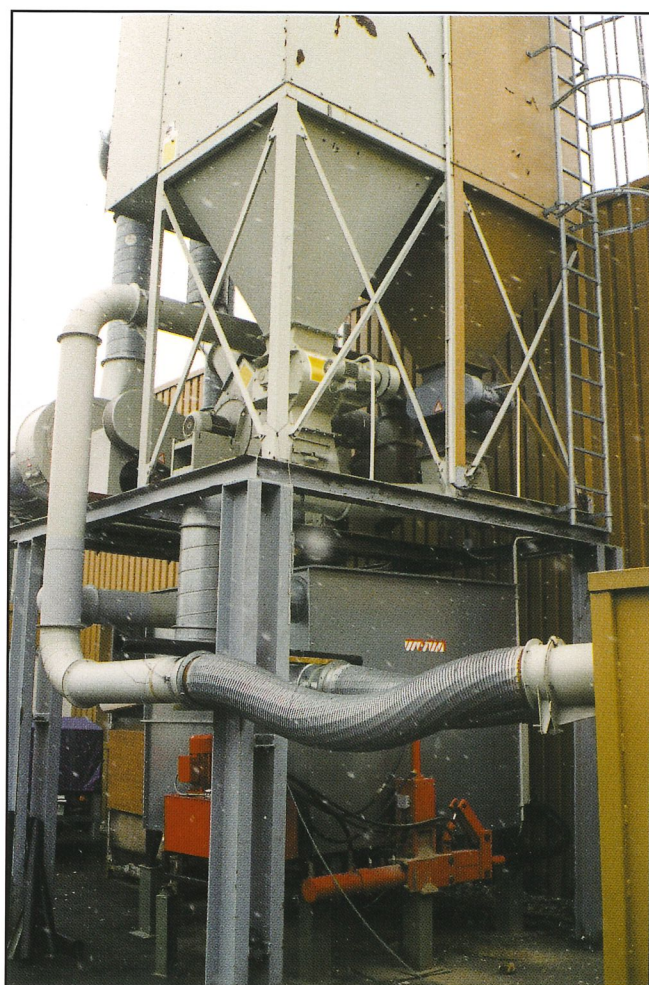
Elimination individuelle assurée par une presse à briqueter WEIMA
