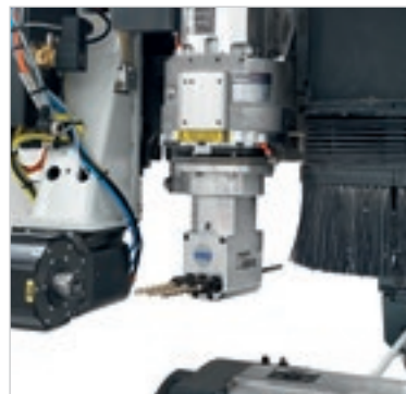
Die Multifunktions-Gruppe , die stufenlos über NC auf 360° positioniert werden kann, kann Aggregate für die Durchführung spezifischer Bearbeitungen aufnehmen (Aussparung für Schloss, Sitze für Scharniere, horizontale Tiefbohrung, Kappen usw.).
