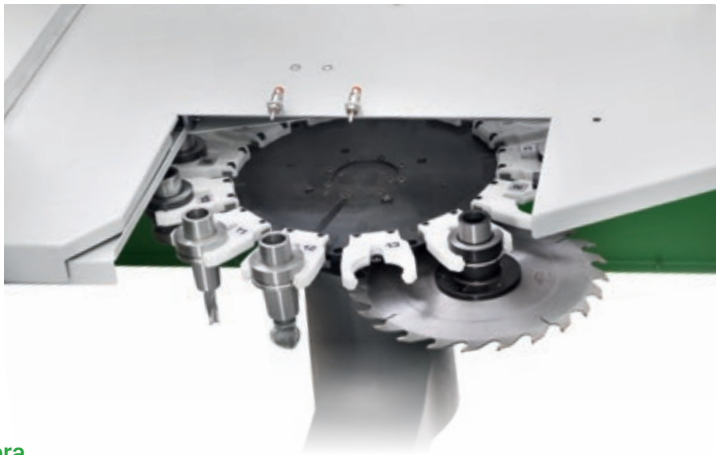
Magazzino utensili a rastrelliera 12/23 posizioni con pick up integrato.
