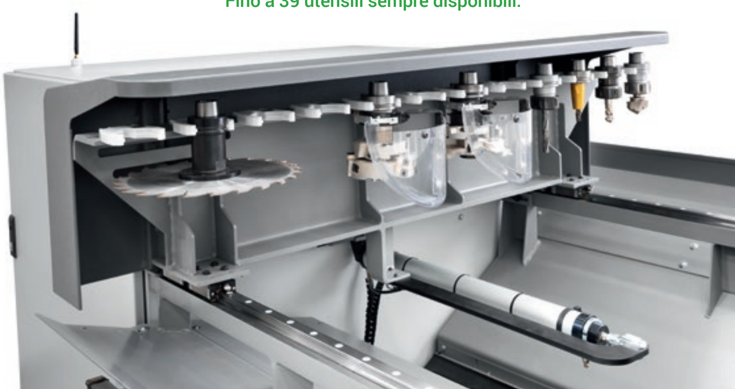
Magazzino utensili a rastrelliera 12/23 posizioni con pick up integrato.
