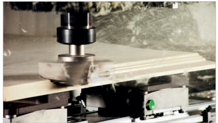
Machining of solid wood doors and gates. Usinage de portes en bois massif. Bearbeitung von Türen aus Massivholz.
