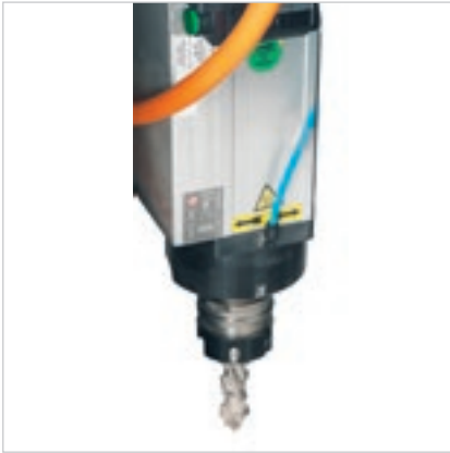
Motore verticale fisso dedicato a lavorazioni accessorie di fresatura (slot, antischeggia, ...).
