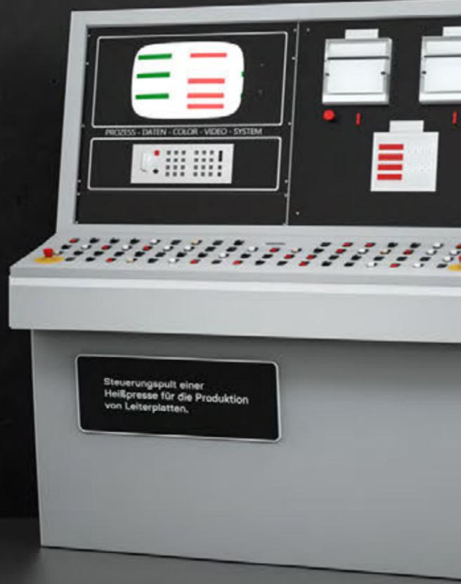
Steuerungspult einer Heißpresse für die Produktion von Leiterplatten.
