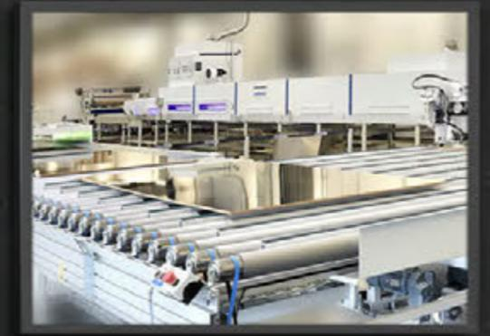
Sorgt für hochglänzende Oberflächen - Lackieranlage für die Beschichtung melaminbeschichteter Spanplatten
