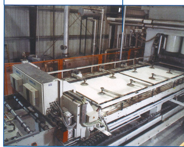
PRESSENENTLEEREINRICHTUNG PRESS UNLOADING SYSTEM
