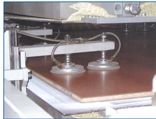
PRESENENTLEERUNG Pressenentleerung durch schwenkbare Vakuumsauger
