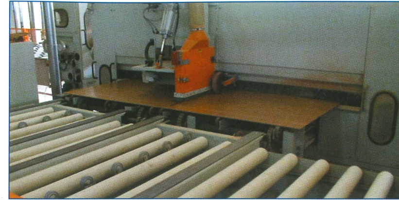
Kantenreinigung mit Mittelschnitt Edge trimming with middle cut
