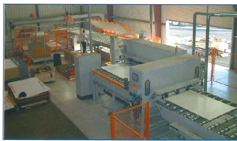
KANTENREINIGUNG, KONTROLLE UND ABSTAPELUNG EDGE TRIMMING, CONTROL AND STACKING
