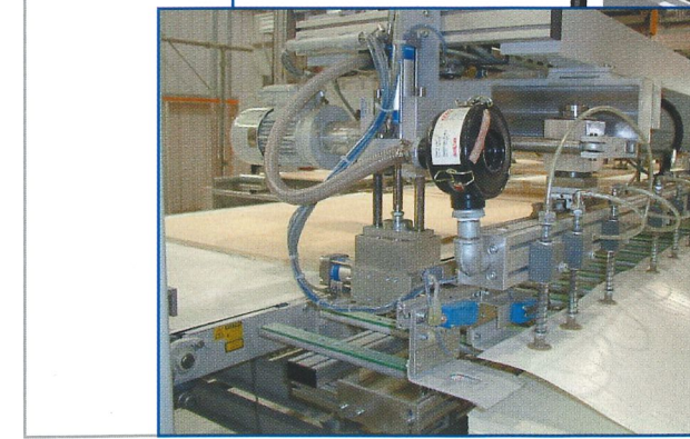
FILMZIEHLEISTE MIT AUSRICHTUNG FILM FEEDER WITH ALIGNMENT
