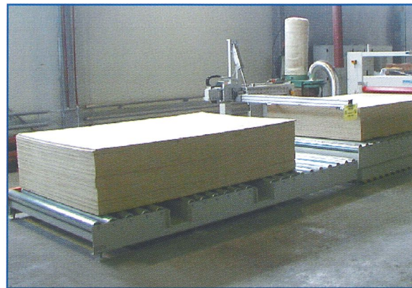
AUTOMATISCHER EINSCHUB und Entstaubung der Trägerplatten
