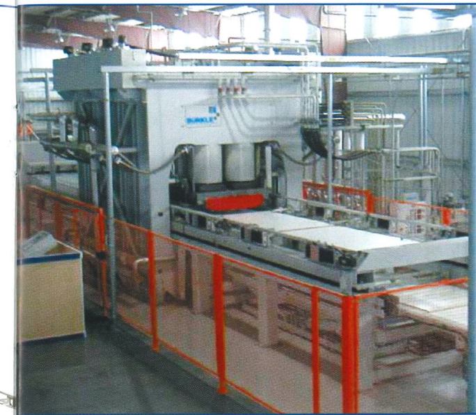
KT-PRESSE MIT BESCHICKSYSTEM SHORT-CYCLE PRESS WITH LOADING SYSTEM
