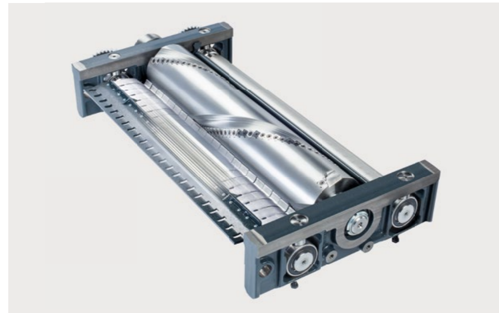
Estabilidad para el máximo rendimiento El soporte de rodamiento macizo de los ejes de cepillo de fundición gris ha sido diseñado para soportar las cargas más elevadas. El rodillo de alimentación dentado de acero y el rodillo de salida microdentado de acero aseguran el perfecto transporte de piezas. Ambos rodillos de acero son de grandes dimensiones y resistentes al desgaste.
