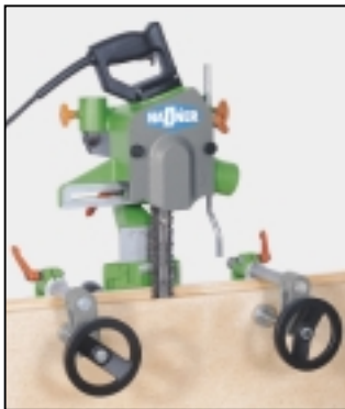
▲ Schlitzeinrichtung für gerade und schräge Schlitz Guide frame for straight and inclined slots Guide pour entailles droites ou obliques
