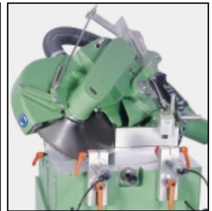
♣ Schifterschnitt Compound cut Coupe d'empannon
