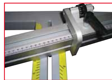
präzise Einstellmöglichkeit des Teleskopanschlags precise adjustment of the telescopic fence
