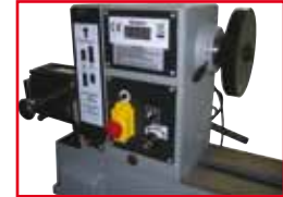
LCD Geschwindigkeitsanzeige serienmäßig LCD speed indication included in delivery
