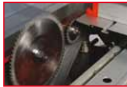
Vorritzer mit eigenem Motor independently powered scoring unit
