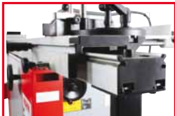
wartungsfreie Rollenführung bei Formatschiebetisch maintenance-free roller guide for sliding table
