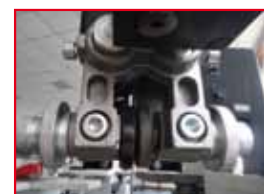
Präzisionsführung oben und Untertischführung für optimalen Sägebandlauf precise saw band guide system above and below the table for perfect saw blade run
