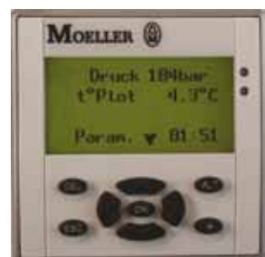
optionale Ausstattung Pressensteuerung PLC optional equipment press control PLC
