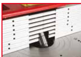
Integral-Sicherheitschiene Integral fence
