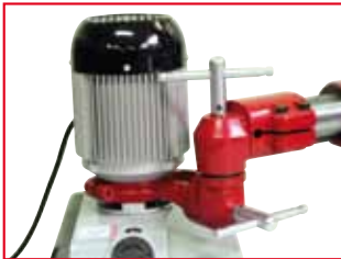
Multifunktionsgelenk für vertikalen und horizontalen Betrieb
