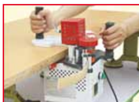
Anleimung an gerade Kanten straight edge bending
