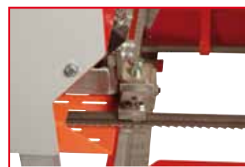
Präzisionssägebandführung precise guide
