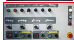
automat. Verstellung des Hauptaggregates mittels Elektromotor, einfache Steuerung der Antriebe durch digitale Anzeige sowie übersichtlichen Bedienelemente
