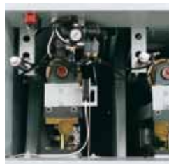
Schutzeinrichtung bei Schleifbandriss broken belt protector
