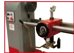
Kopiervorrichtung bei DBK Modellen copy device at DBK models
