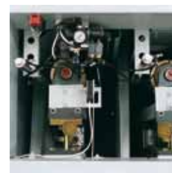
Schutzeinrichtung bei Schleifbandriss broken belt protector
