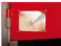
Bandspannungsanzeige band tension indicator
