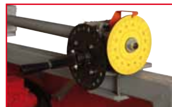
Höhenverstellung des Sägeaggregats erfolgt über Handrad mit Skala height adjustment of saw unit via hand wheel with scale
