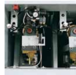
Schutzeinrichtung bei Schleifbandriss broken belt protector
