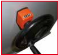
Zählwerk Tischhöhenverstellung 0,1mm counter block at thicknessing table 0,1mm
