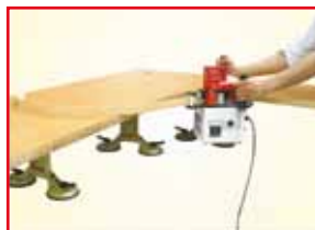
Anleimungen an Schweifungen / Radien curve edge bending
