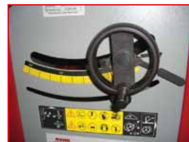
Sägeblatthöhenverstellung saw blade height adjustment
