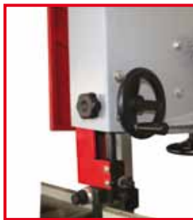
Führung mittels Handrad verstellbar guidance adjustable via hand wheel
