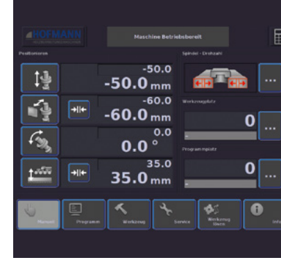
Guardian Überwachung der Anschlagbacken- klemmung in der CNC-Steuerung
