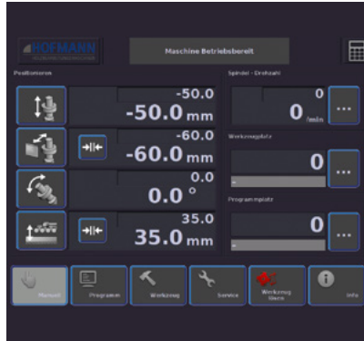
Werkzeugwechsel Lösen der HSK-Schnittstelle über das Touch-Bedienfeld
