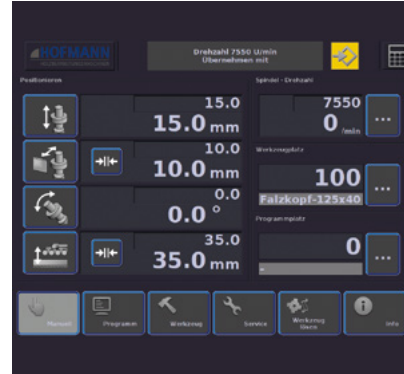
Spindelstart Stufenlose Drehzahlvorwahl
