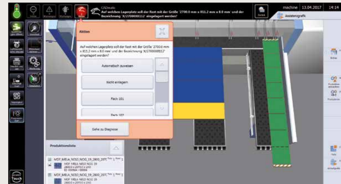
CADmatic 5 Kontrollierte Resteeinlagerung
