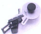
Handkappgerät zum stoßgenauen Abschneiden der Kanten.
