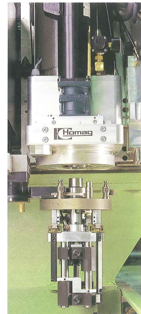
Hauptspindel mit universeller Schnittstelle.
