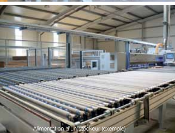
Alimentation d'un stockeur (exemple)
