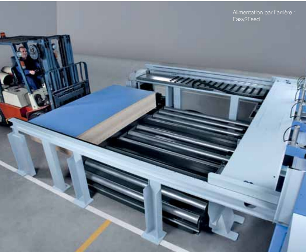
Alimentation par l'arrière : transporteur à rouleaux à deux étages
