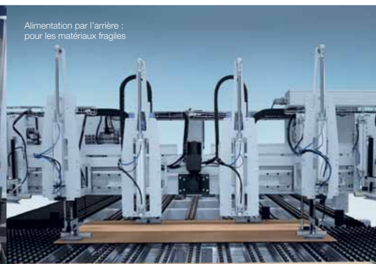
Alimentation par l'arrière : chariot d'insertion à ventouses profilLine
