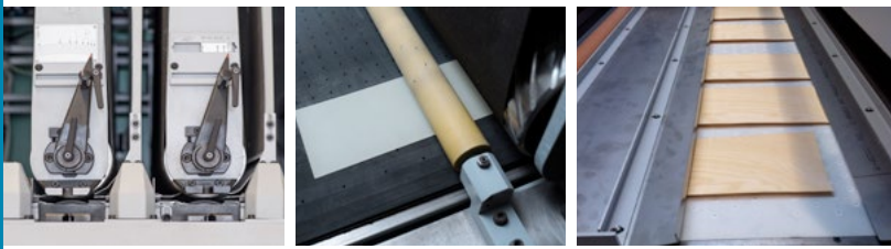
Hochpräzisions-Schleifanlagen (für Furnier, HPL, Kork etc.)
