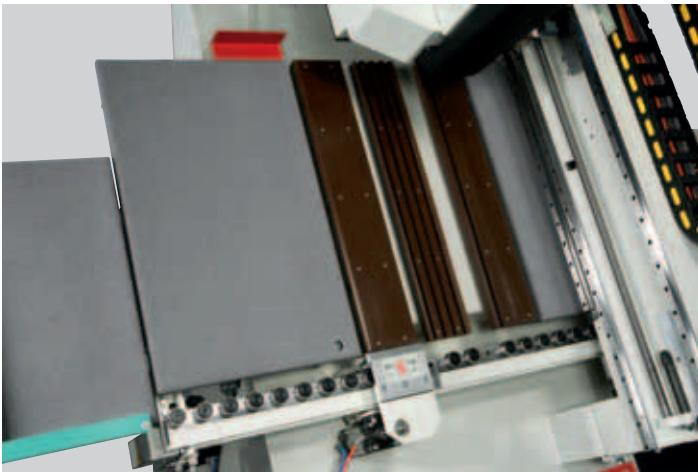
Qualità e tecnologia di alto livello con il **piano di lavoro in bachelite**, garanzia di un ottimo allineamento, stabilità e leggerezza. Piani laterali rivestiti in moquette FLOTEX, ignifuga e antiruggio.
