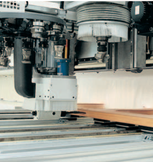
Universal K2 Aggregate Fest oder CNC-gesteuert 0-360°. Für Horizontalbearbeitungen.
