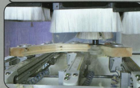
Der Vakuumtisch ist für größte Vielseitigkeit ausgelegt und ermöglicht Bearbeitungen jeder Art und Form. Mit dem praktischen Werkstückspannsystem mit Spannbacken oder Saugnäpfen ist er ideal zur Fertigung von Türen, Fenstern und Möbelementen aus Massivholz, Spanplatten oder MDF.
