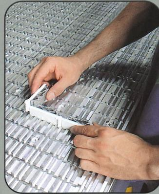
Dank der Auswahlmöglichkeit zwischen verschiedenen Werkstückspannsystemen eignet sich dieser Arbeitstisch ganz besonders für jene Betriebe, die Prototypen und Sonderteile herstellen und zu häufigen Bearbeitungswechseln gezwungen sind.
