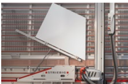
Das Winkelschnittgerät WSG hält das einmal eingestellte Mass in allen Winkeleinstellungen exakt.
