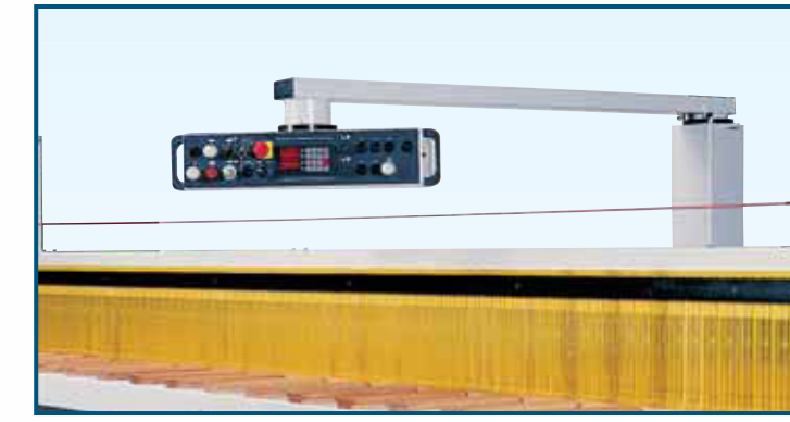
Pannello comandi pensile (opzionale). Panneau de commande suspendu (option). Controls panel on swinging arm (option). Hängesteuertafel (auf Anfrage).
