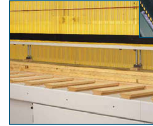
Pressori verticali pneumatici (optional) Presseurs pneumatiques verticaux (option) Pneumatic vertical hold-down arms (optional) Senkrecht-Druckluftzylinder (auf Anfrage)
