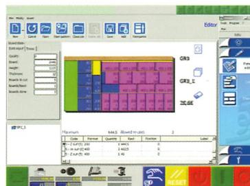
La funzione "tagli XY" permette una rapida e semplice programmazione della sequenza di taglio e il G-Vision identifica questo inserimento mediante una semplice segnalazione grafica.
