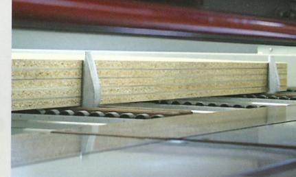
Allineatori frontali effettuano l'allineamento del pacco di pannelli prima che abbia inizio il ciclo di sezionatura longitudinale.
