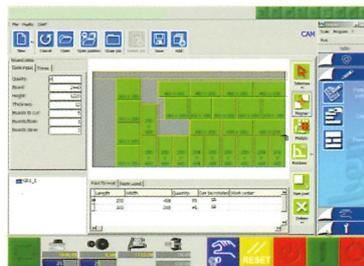
La funzione "editing" permette l'inserimento di nuovi schemi di taglio, con macchina in funzione, e la visualizzazione grafica degli schemi, resti e pezzi ordinati.
