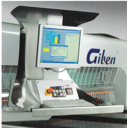
Grafische Simulation in Echtzeit der verschiedenen Bearbeitungsphasen.
