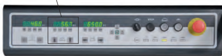
Electronic digital display LCD for blade lifting Elektronische LCD-Anzeige für Sägeblatthöhenverstellung Электронный счетчик LCD подъема пилы
