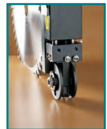
Knife scoring unit Vorritzer mit Messern Подрезной узел с ножичками
