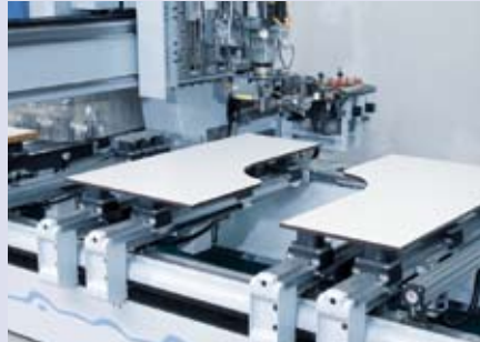
Spostamento laterale delle traverse dopo la sezionatura dei pannelli grezzi per la fase di bordatura
