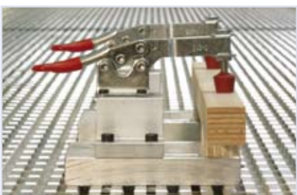
Tavolo a griglia in alluminio con scanalature che permette un bloccaggio preciso grazie a elementi di fissaggio meccanici in qualsiasi posizione
