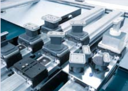
Diversi tipi di elementi di bloccaggio con vuoto d'aria e pneumatici per garantire una precisa lavorazione dei diversi materiali e pezzi
