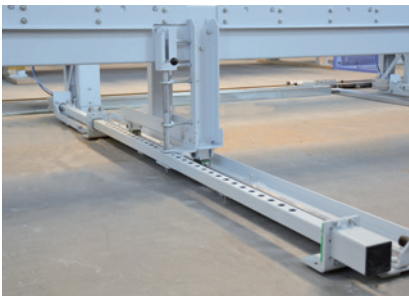
Präzisions-Führungsschiene für manuelle Breitenverstellung.
