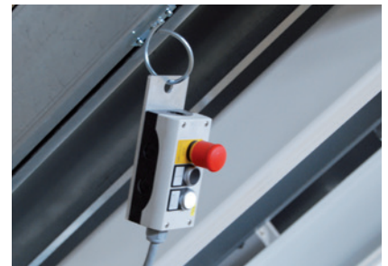
Bedienflasche (flexibel am Tisch angebracht) Steuerung ist im Tisch integriert.
