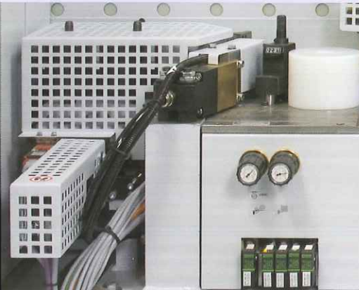
Automatische Verstellung der Druckzone auf die jeweilige Kantendicke über Programm
