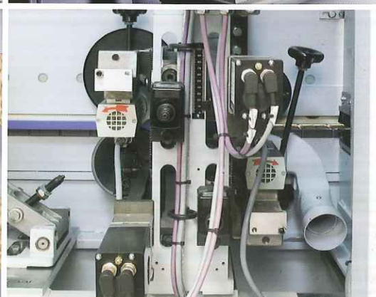
Fräsaggregat 0,4 kW (automatisch statt manuell) zur automatischen Verstellung Fase/Radius über Programm
