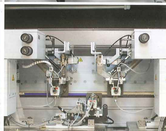
Formfräsaggregat FF 12 (automatisch statt manuell) zur automatischen Verstellung Fase/Radius über Programm
