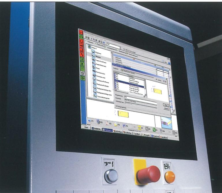
powerControl Steuerung PC22: Zur effizienten Bedienung und einfachen Programmierung Ihrer Maschine.
