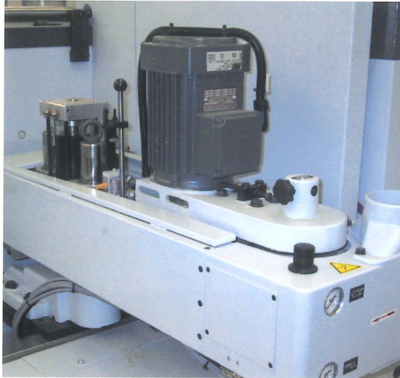
Bandschleifaggregat KS 10 Zum Schleifen gerader Furnier- und Massivkanten.
