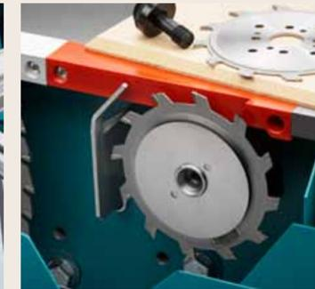
Elektrisch verstellbares 2-Achs-Vorritzaggregat T60A20
