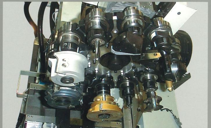
Bei dieser Konfiguration ist es möglich, **gleichzeitig an zwei Platten die gleiche Fräsbearbeitung auszuführen**; dadurch verdoppelt sich die Produktionskapazität der Maschine.
