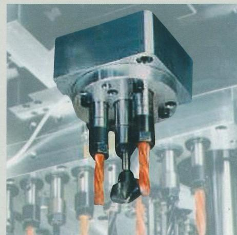
Bohraggregat für Topbandbohrungen auf **Schnittüren und Küchenfronten.**
