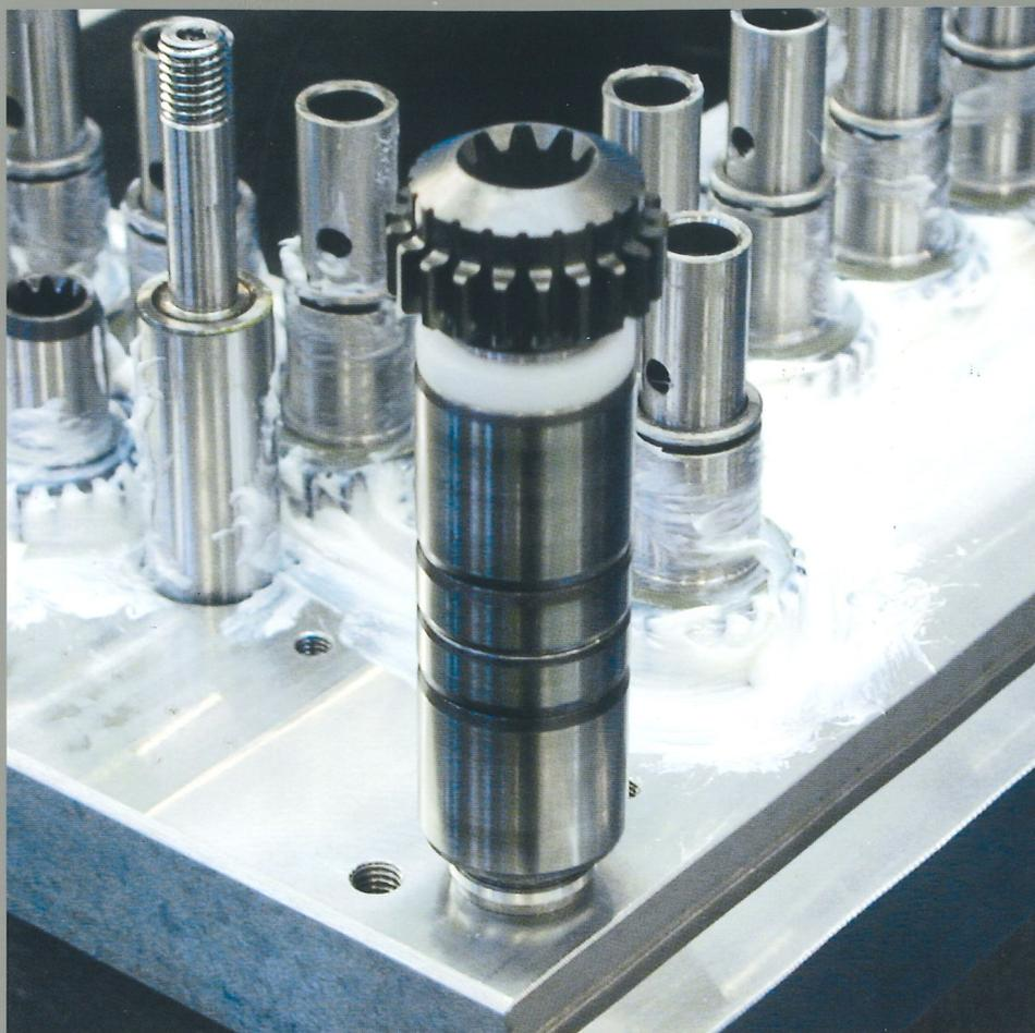
Alle Bohraggregate der Morbidelli Bearbeitungszentren sind mit den neuen (patentierten) Integrallagern hergestellt und können Drehgeschwindigkeiten bis zu 6000 U/min erreichen. Diese Lösung bringt im Konkreten Folgendes:
