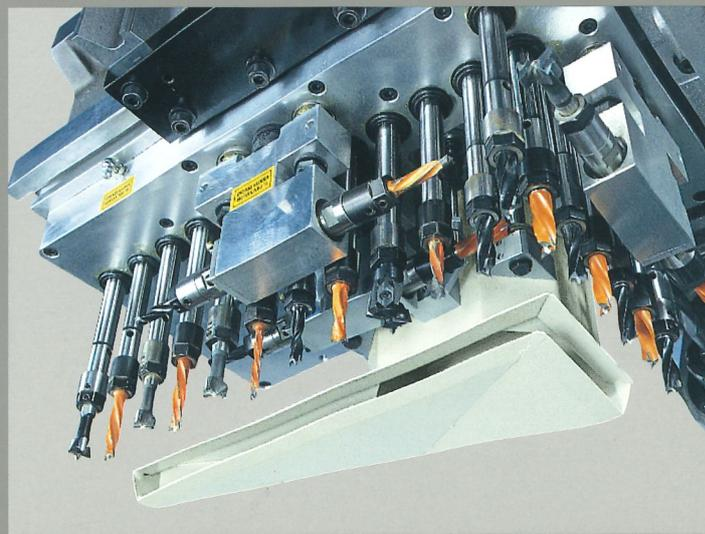
Für Anforderungen für hohe Produktionskapazität bei der Bohrung, wie bei Seitenteilen **von Schränken und ähnlichem**, ist ein Bohraggregat mit 30 Vertikalspindeln und ein zusätzlicher Kopf mit 11 Spindeln mit NC-Bewegung auf der Y-Achse verfügbar.
