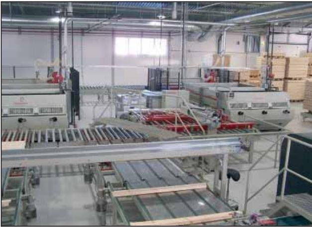
Die Verleimlinie kann durch zahlreiche Zubehörteile ergänzt werden. Förderbänder, die sich vor und hinter der Hobelmaschine befinden, Sortierstationen und weitere Förderbänder verringern die erforderliche Lagerfläche und beschleunigen die Produktion.
