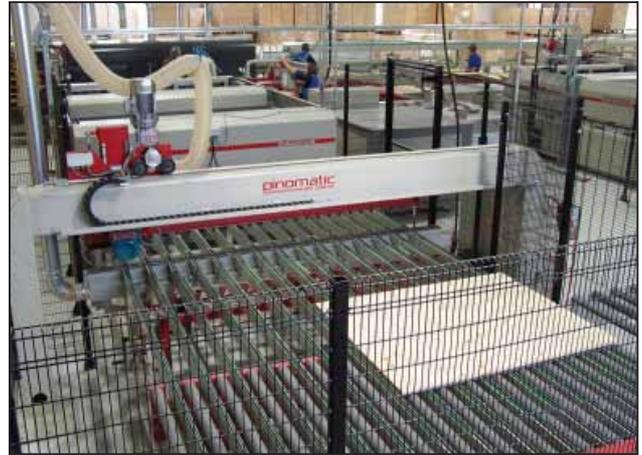
Die in die Pressenstraße integrierte Quersäge sorgt für eine genaue Plattenbreite und erzielt eine Rohmaterialeinsparung von bis zu 8%! Die Straße kann ebenfalls mit einer Quersäge, Reparaturstationen sowie Stapelanlagen ausgestattet werden.
