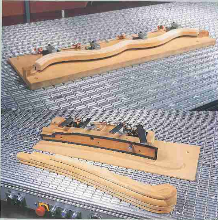
Die T-Nuten und die Gewindebohrungen sichern eine perfekte Befestigung für sämtliche Spannvorrichtungen.
