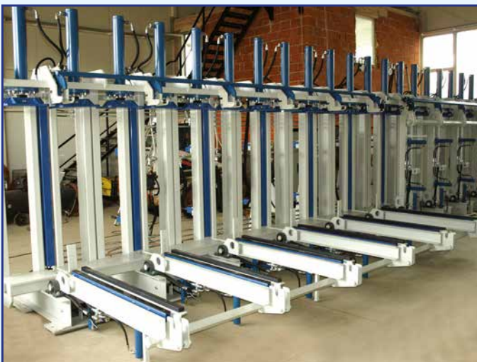
Gluelam press Presse für Leimbinder Strettoio per l'incollaggio di travi Presse pour lamellés collés Prensa para el encolado de vigas
