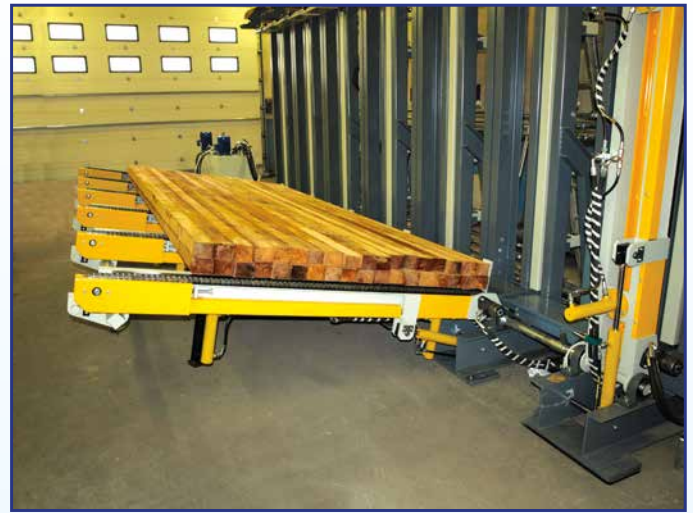
Press is equipped with device for automatic filling and discharging Die Presse kann mit einer automatischen Be- und Entladung ausgerüstet werden Riempimento e svuotamento dello strettoio con l'aiuto della catena Remplissage et vidange de la presse à l'aide d'une chaîne Llenar y vaciar la prensa con ayuda de la cadena
