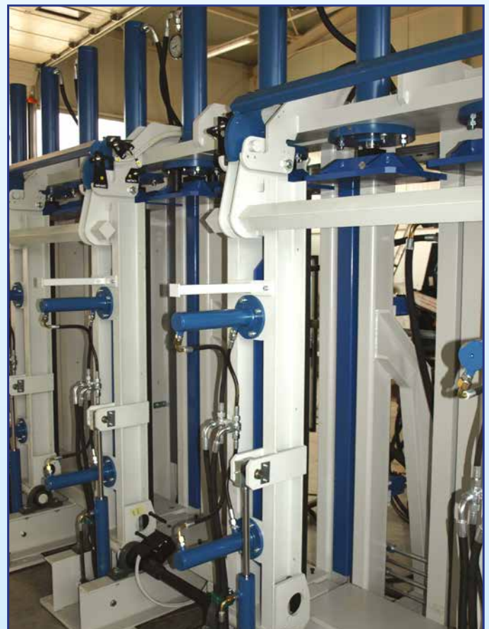
Straightening cylinder in front side, movable supports rear Ausgleichzylinder vorne, verstellbare Anschläge hinten Cilindri di accomodamento frontali, guide mobili posteriori Cylindre de raccomodement avant, appui mobile arrière Cilindros de arreglo en la parte delantera, superficie móvil de apoyo en la parte trasera
