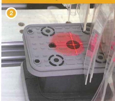
Einfaches Positionieren der Sauger durch den Fadenkreuzlaser
