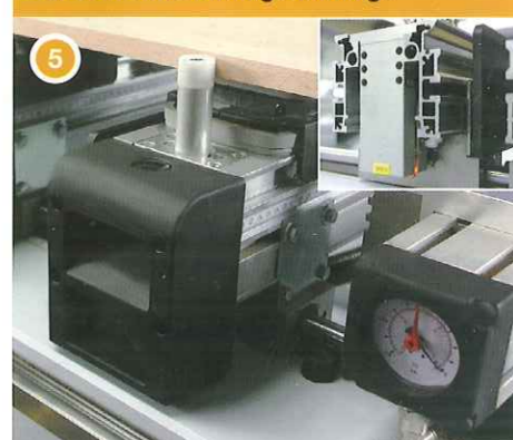
Erhöhte Sicherheit durch eine elektronische Endlagenabfrage an allen vorhandenen Anschlagzylindern
