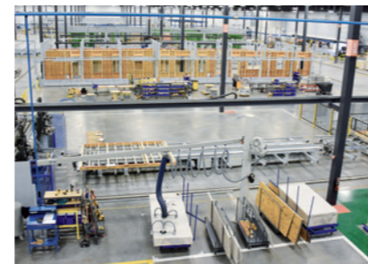
Geschlossene Wandfertigung Blueprint Robotics, USA
