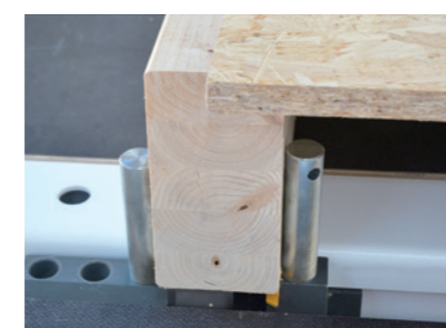
Dach-Decken-Spanner erleichtern das Einlegen und Fixieren der Dachsparren und Deckenbalken.
