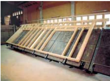
Einlegetisch, Aufstelltisch, Giebeltisch, Dach- und Deckentisch – universeller Einsatz ist ohne zusätzlichen Aufbau oder aufwendige Umrüstungen durch modernste druckluftgesteuerte Spannvorrichtungen in Kombination mit Steckbolzen möglich. Mit seiner Qualität gewährleistet der Weinmann-Zimmermeistertisch hohe Maßhaltigkeit und Winkelgenauigkeit. Weitere Infos siehe ab Seite 4.
