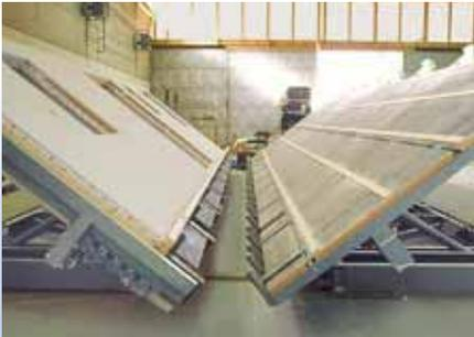
Der individuelle Tisch nach Kundenwunsch, fast alle Möglichkeiten sind ausführbar: zum Beispiel zwei Tische an den Querseiten einander gegenüber, kombiniert mit zwei Querfahrwerken; oder zwei Tische längs hintereinander, kombiniert mit je einem Fahrwerk in Längs- und Querrichtung. Vorbereitet für die Kombination mit einer WMS Multifunktionsbrücke. Weitere Infos siehe Seite 8.
