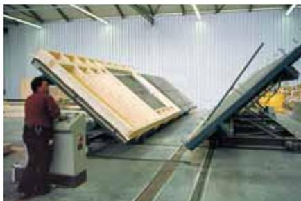
Der Ausbau des Zimmermeistertisches (Gebertisch) zum Schmetterlingswender erfolgt durch Erweiterung mit einem zweiten Tisch (Nehmertisch). Der automatische Wendevorgang vereinfacht das Handling der Elemente. Die Produktion von geschlossenen Elementen mit einem definierten Produktionsablauf führt zu einer höheren Produktivität. Weitere Infos siehe Seite 10.
