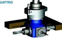
Das Aggregat Typ "QUATTRO" besitzt vier im 90°- Winkel angeordnete Werkzeugaufnahmen.
