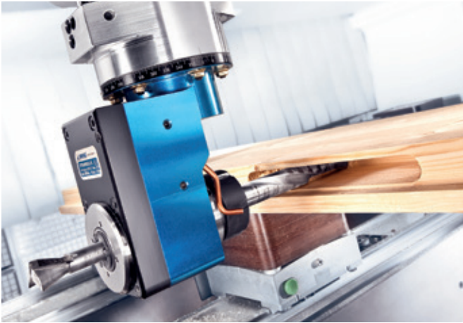
Fräsen von Schlosskasten und Stulp
