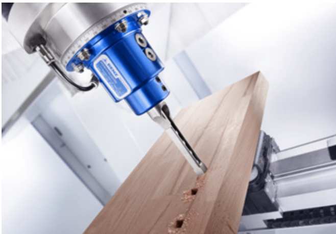
Staketenlochbohrungen bei Treppenstufen
