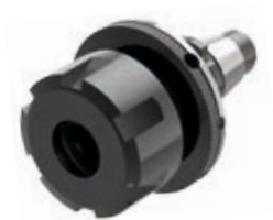
Spannzangenaufnahme mit außenliegender Spannmutter nach DIN6499 Spannbereich ER 25 Ø2-Ø16 ER 32 Ø2-Ø20
