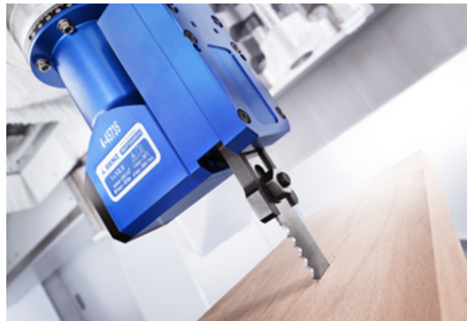
Vertikales Einbringen von Schlitzern für Fitschenbänder
