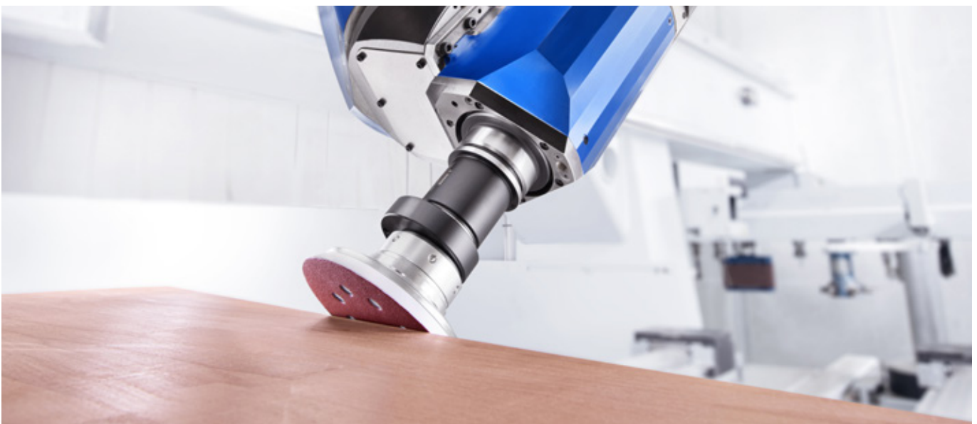
Fasenschleifen an einer Treppenstufe
