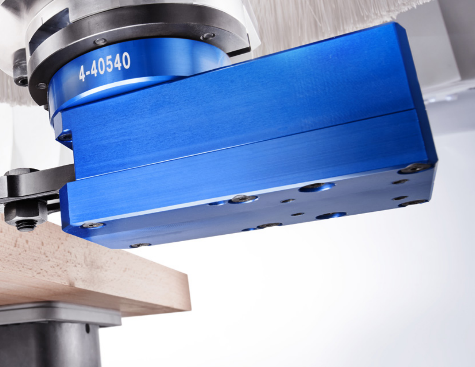
Horizontales Einbringen von Schlitzern für Fitschenbänder
