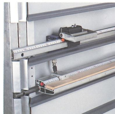
**Einzelne Klappschienen** zwischen den Schnittstellen. Plattenabschnitte auf dem hinteren Teil der Maschine können stehenbleiben, da die Klappschiene nicht als Gesamtheit herausgeklappt wird.
