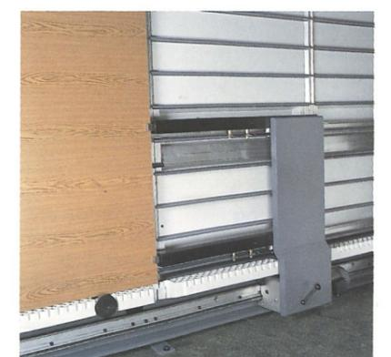
**Programmierbarer Materialschieber** (nur 1222) der das Material genau positioniert. Ablauf: Das Maß wird eingegeben und dann geht alles wie von selbst. Nach Freigabe heben sich die Rollen, der Materialschieber wird positioniert, die Rollen senken sich und der Sägeschnitt kann ausgelöst werden. Der Streifen braucht nur noch abgenommen zu werden.
