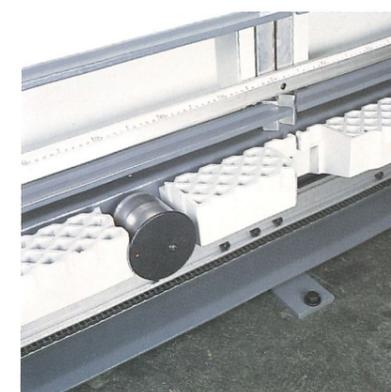
**Der Staub ist durchgefallen**, durch die robusten Aluminium-Auflagen, die selbstverständlich nach HOLZ-HER Tradition nachbesäumbar sind und auch kleinen Plattenabschnitten einen sicheren Halt bieten.
