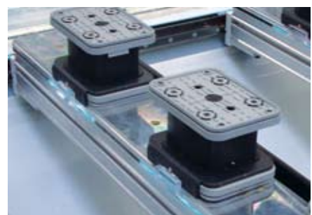
Konsolentisch für die exakte Teilefixierung
