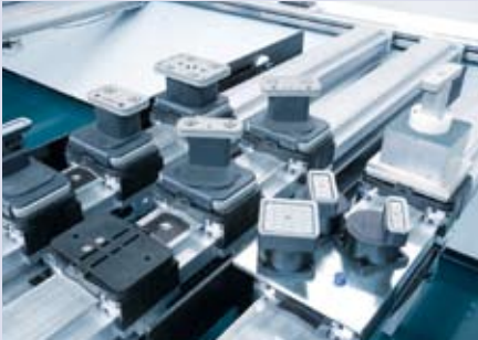
Unterschiedliche Vakuum- und Pneumatikspannelemente garantieren eine exakte Bearbeitung unterschiedlicher Werkstücke und Werkstoffe
