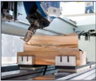
Die hochsteife Auslegerkonstruktion ist ausgelegt für die DRIVE5+ 5-Achs-Frässpindel mit einer maximalen Werkstückhöhe von 300 mm – und das auch bei Werkzeuglängen von 230 mm (inkl. HSK-Aufnahme)
