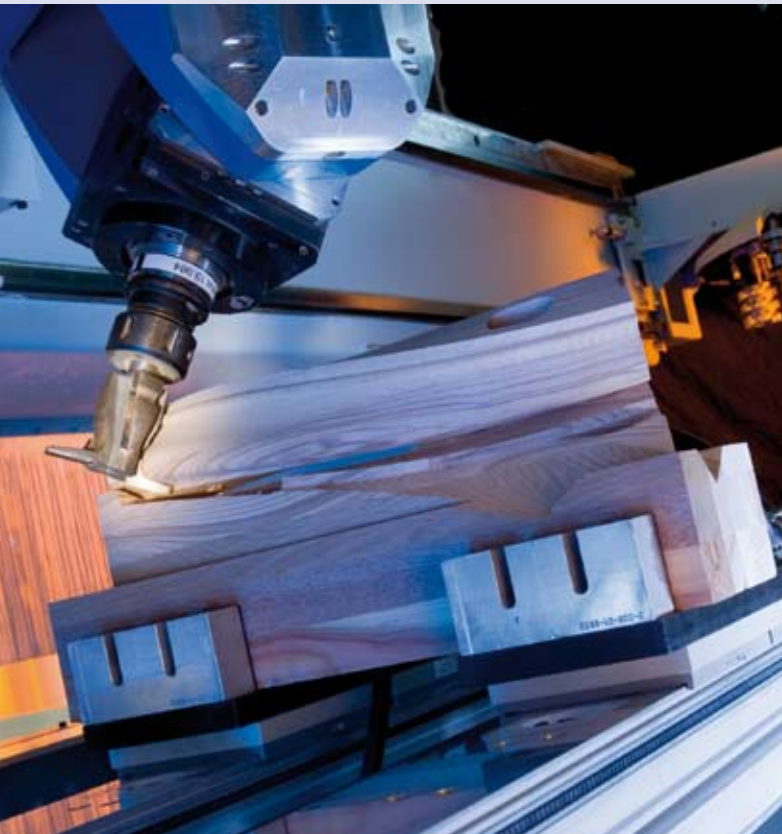
DRIVE5+: Wahlweise 3-, 4- oder 5-Achs-Frässpindeln mit Zugriff auf bis zu 72 Werkzeuge und Aggregate
