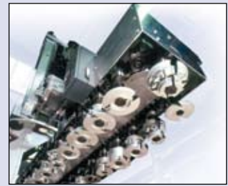
Schnelleres Rüsten durch reduzierte Wechselzeiten – die 30- oder 72-fach Kettenwechsler erledigen das in ca. 8 sec.
