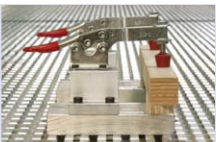
Genuteter Aluminium-Rastertisch gewährleistet die präzise Fixierung durch mechanische Spannelemente an jeder beliebigen Stelle
