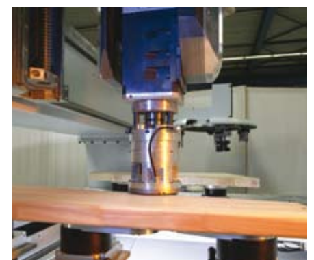
DRIVE5+ Frässpindel mit vertikal getastetem Aggregat
