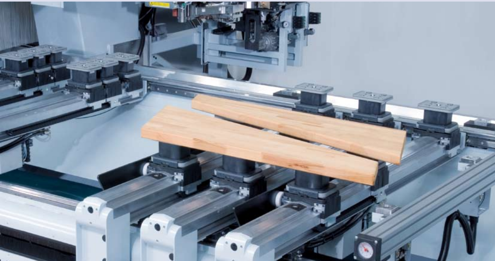
Automatisches Umspannen von Treppenstufen
