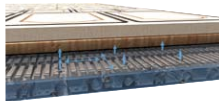
Genuteter Aluminium-Rastertisch gewährleistet die präzise Fixierung durch mechanische Spannelemente an jeder beliebigen Stelle
