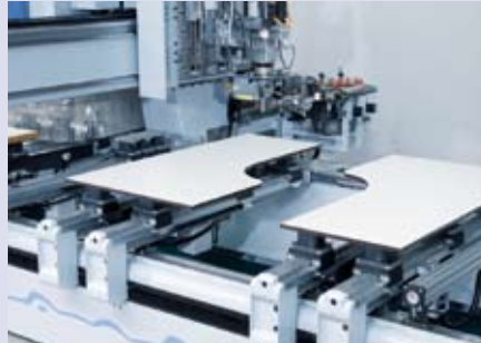
Seitliches Verfahren der Konsolen nach dem Auftrennen der Rohplatten zum Kantenanleimen
