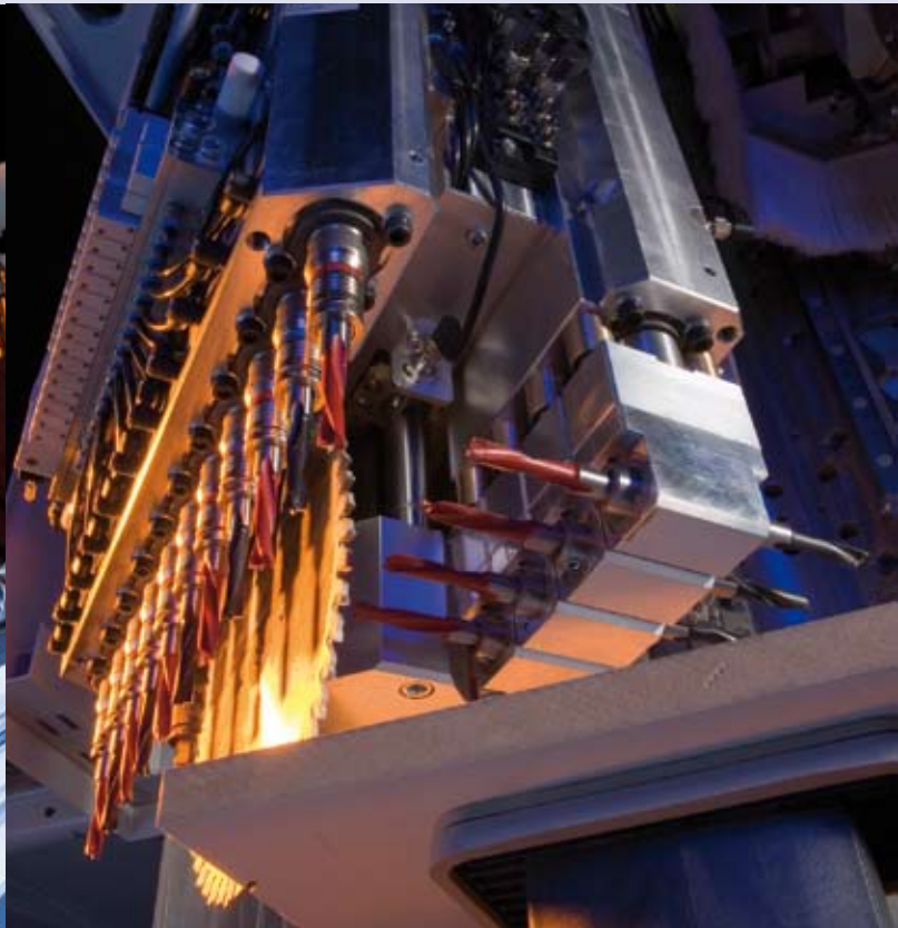
Verschiedene High-Speed-Bohrköpfe mit integrierter Säge, Frässpindel – exklusiv auch 360° schwenkbar
