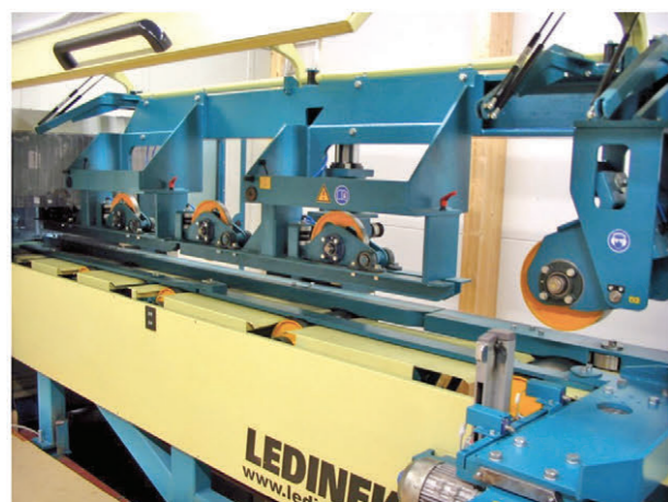
Maschine und Beschickung aus einer Hand. Die gesamte Längslinie ist mit der POWERFEED Hobelbeschickung und den Bremsbändern lieferbar. Bis zu 150 Takte in der Minute.
