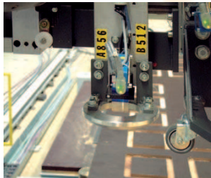
Markieren/Beschriften mit Inkjet/ Farbstift oder Reißnadel
