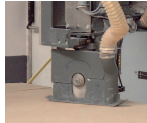
Klammern mit bis zu 10 Klammern/sec Sägen mit max. ca. 30 m/min (geräteabhängig)
