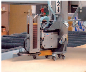
Klammern mit bis zu 10 Klammern/sec Sägen mit max. ca. 30 m/min (geräteabhängig)
