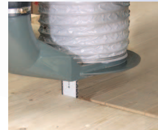
Sägen bis ca.350 mm Schnitttiefe, Vorschub je nach Material und Materialdicke
