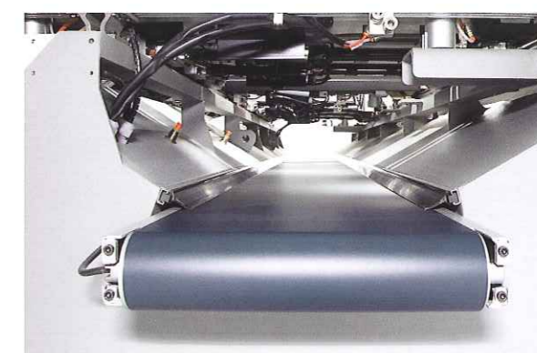
Späneförderbänder für die Entsorgung von Spänen und Bearbeitungsabfällen.
