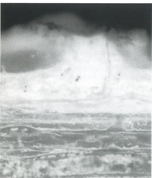
Längsschnitt durch grundierte Holzoberfläche bei Kiefer bei 200facher Vergrößerung; eine einzelne aufrecht stehende Holzfasern durchbricht den Grundierungsfilm.
