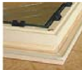
Encollage des champs, assemblage et serrage avec le cône Hoffmann.
