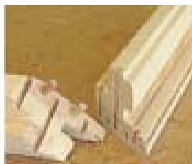
Sciage à 45° de l'ouvrant bois, fraisage, perçage et mise en place des tourillons.
